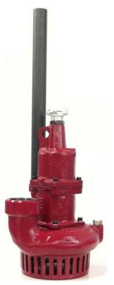
Principais propriedades das bombas pneumáticas centrífugas de imersão: robustas, compactas, portáteis, de alta capacidade e baixa manutenção. São auto-escorvantes e operam total ou parcialmente submersas no líquido a ser bombeado; não necessitam de suporte de fixação, bastando colocá-las na posição vertical dentro do fluido.
